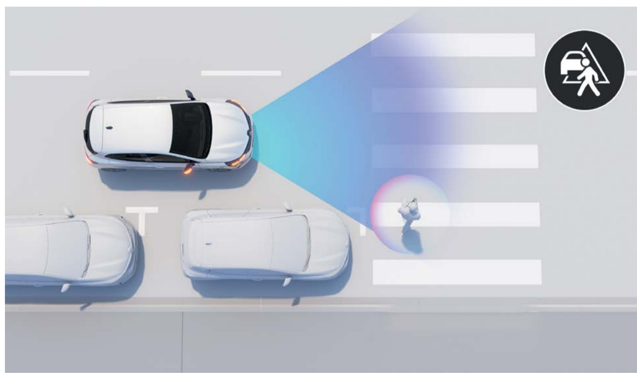
samodejno zaviranje v sili Voznika opozori na neposredno nevarnost čelnega trka v mirujoče vozilo pri majhnih hitrostih. Sproži samodejno zaviranje v sili, da se izogne trčenju ali ga ublaži.
